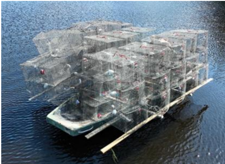
Kuva 3. Katiskojen kuljetukseen kehitettiin yksinkertainen puuteline, jonka avulla veneeseen voitiin ottaa kyytiin 40 katiskaa yhdellä kertaa.
